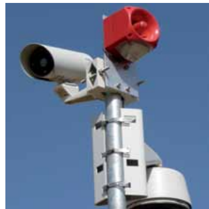
В точке наблюдения установлены тепловизионная камера FLIR Systems SR-серии, звуковой и световой маяк и купол с системой видеонаблюдения.
