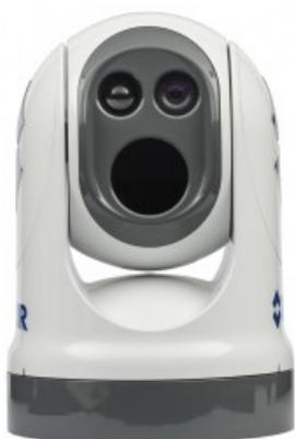
Новинка 2015 года — мультисенсорная тепловизионная система для стационарной установки на яхтах и катерах. Оснащена тепловизором с матрицей 640 x 480 пикселей, 30-кратное оптическое приближение и поворот на 360° с углом наклона 90° позволяют безошибочно распознавать цели на ближних и дальних расстояниях. Высокая детализация объектов на тепловом изображении.
