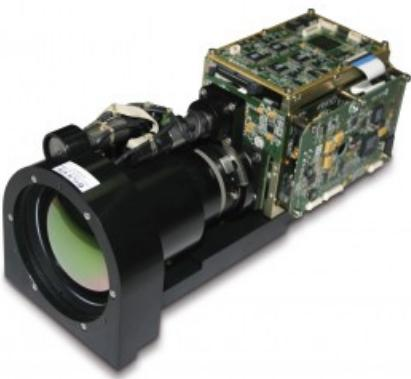
Линейка компактных тепловизионных модулей, работающих в спектральном диапазоне 3-5 мкм. Предназначен для интеграции в наземные наблюдательные системы дальнего радиуса действия, беспилотные летательные аппараты и авиационные подвески. Модули могут оснащаться различными объективами по требованию заказчика.
