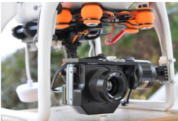
Компактный модуль FLIR Tau 2 относится к семейству неохлаждаемых тепловизионных модулей нового поколения для длинноволнового ИК-диапазона. Идеально подходит для интеграции в портативные устройства и установки на БПЛА.
