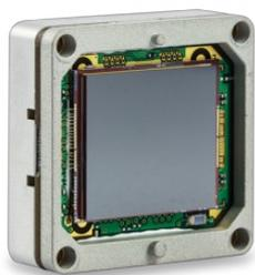
Неохлаждаемый тепловизионный модуль для разработчиков OEM устройств. На выбор два вида ик-детекторов 640 x 512 и 336 x 256.
