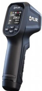
FLIR TG56 – это портативный инфракрасный термометр, бесконтактно измеряющий температуру поверхности простым наведением лазерного указателя на предмет обследования.
