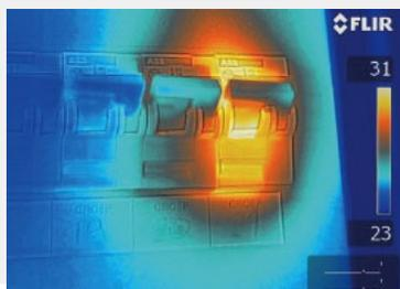
ИК-изображение того же предохранителя с использованием функции MSX. Видно текст ниже предохранителя, что упрощает ремонт нужного предохранителя на более поздней стадии.
