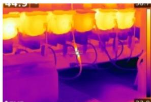
T1020 – Плохое электрическое соединение на двигателе
