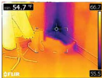
Область с холодным участком указывает на проникновение воздуха
